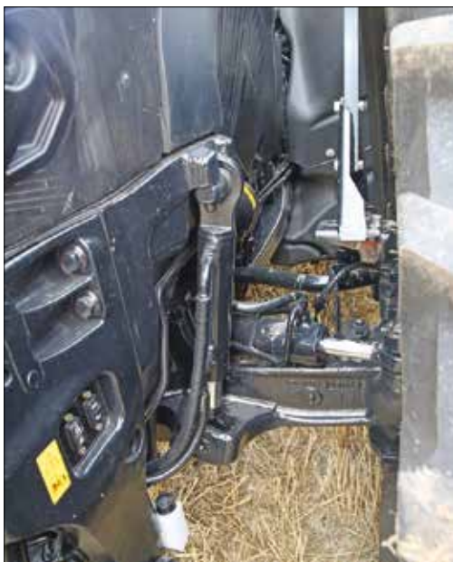
En ny og stærkere foraksel er længe ventet fra Case IH. Forakslen er godkendt til kørsel med tvillinghjul og kommer fra Magnum-serien. Stemplet til affjedringen har en vandrang på 110 millimeter.
