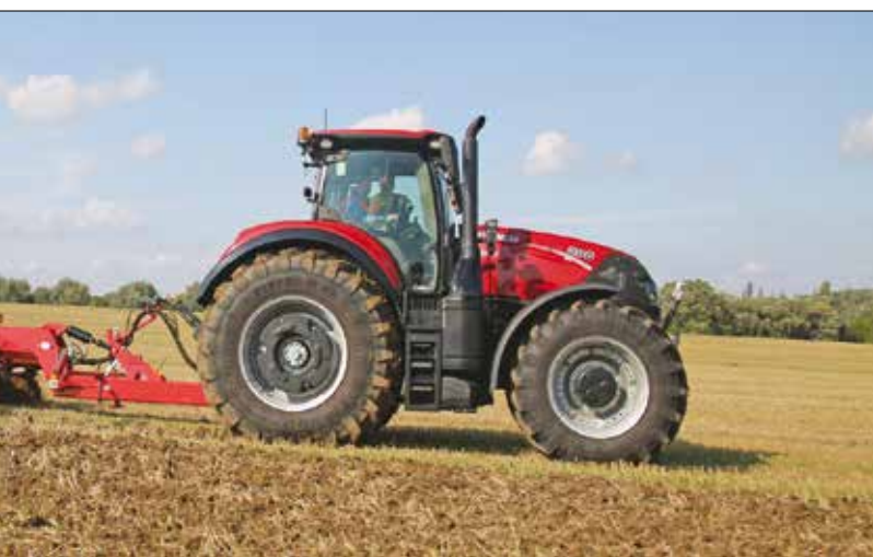
Stor diameter på baghjulene sikrer optimal overførsel af effekt til landjorden. 710/75 R42 med en diameter på 2,15 meter er standard udstyr.
