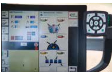
Fra Varioterminalen, kan jeg flytte rundt på samtlige hydraulikventiler til de forskellige knapper på højre armlæn og joysticket.
