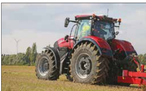
Stor diameter på baghjulene sikrer optimal overførsel af effekt til landjorden. 710/75 R42 med en diameter på 2,15 meter er standard udstyr.
