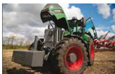
Motoren leveres fra Deutz AG og er på 7,7 liter - bundtrækket er blevet højere ved lavere omdrejninger på den nye motor.
