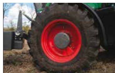
Testtraktoren var udstyret med VarioGrip - integreret dæktryksregulering i alle fire dæk fra traktorens terminal
